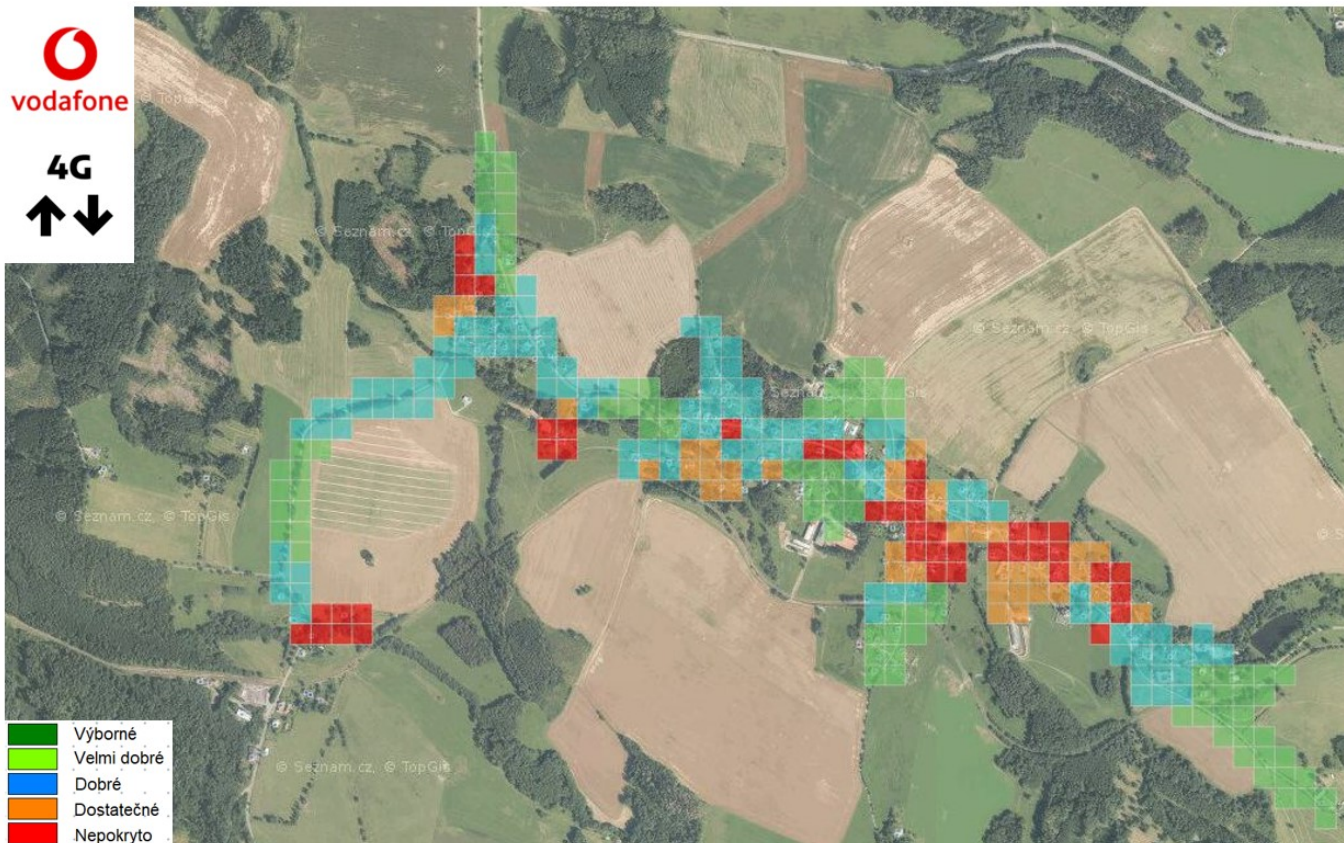
Obr. 9 Pokrytí z pohledu rychlosti stahování operátora Vodafone v síti LTE.
